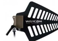
LBP-LNP 액티브 와이드밴드 IEM/IFB 안테나 - 435-1300 MHz - 6 dBi, 지향각 90°, SWR 1:1.2 - 부스터 증폭: Max. 20 dB
