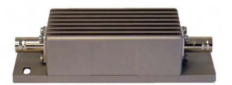
PAW 와이드밴드 MFL 안테나 앰프 - 435-698 (PAW-L), 470-960 MHz (PAW-X) - 증폭 (Max.): 20 dB - 120 x 48 x 29.5 mm, 250 g
