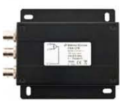
CSA121B 패시브 콤바이너/스플리터 - 콤바이너→ 1 x 2:1, 스플리터→ 1 x 1:2 - 입력신호: 최대 2W - DC 패스-스루
